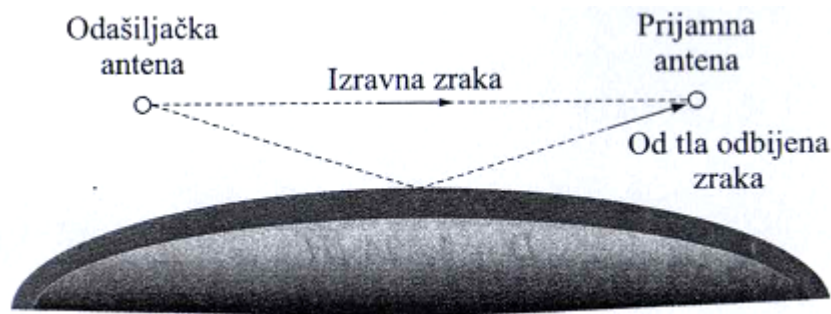
Slika 6.1 Rasprostiranje radiovala između antena u vidokrugu
